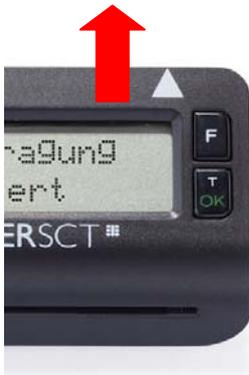
Zur Inbetriebnahme des TAN-Generators ziehen Sie bitte zuerst den Isolationsstreifen in Pfeilrichtung heraus. Der TAN-Generator startet nun sein Betriebssystem und zeigt kurz den Gerätenamen und die Versionsanzeige im Display an. Dieser Vorgang dauert nur wenige Sekunden, danach erlischt die Anzeige im Display. Ihr tanJack® optic SX ist nun einsatzbereit.
