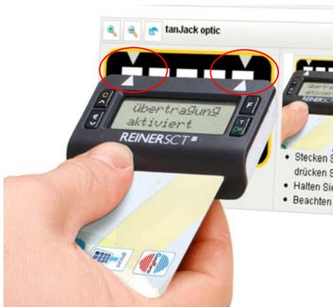
Halten Sie das Gerät so lange mit der Rückseite vor die blinkenden Felder Ihrer Banking-Anwendung, bis das Gerät „Übertragung erfolgreich“ anzeigt.
