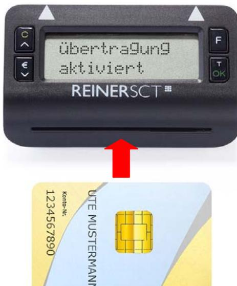
Führen Sie Ihre für das chipTAN comfort-Verfahren registrierte Chipkarte wie abgebildet, mit dem Chip nach vorne in den Kartenschlitz des tanJack® optic SX ein.
